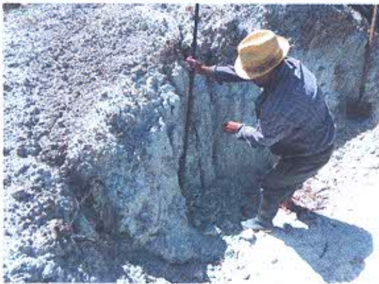
FOTOGRAFIA NRO. 8. Extracción de la tierra "azul" para elaboración de pintura de edificaciones del sector.
